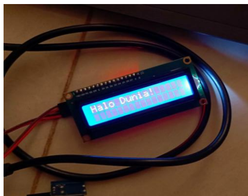
Gambar 5. Pengujian LCD I2C Sumber : Penulis, 2026
